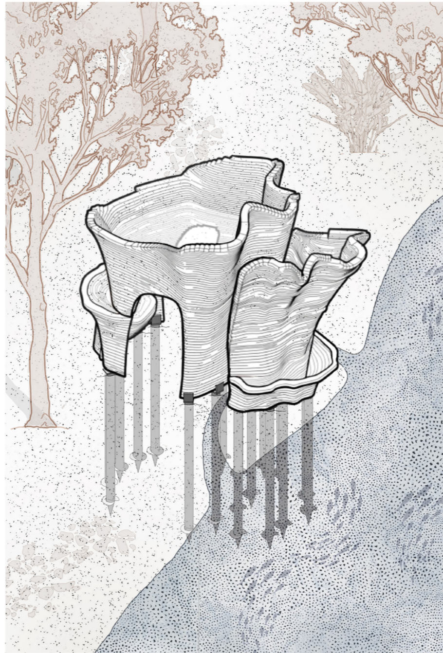
УСТАНОВКА ПАВИЛЬОНА НА ВИНТОВУЮ ОСНОВУ
