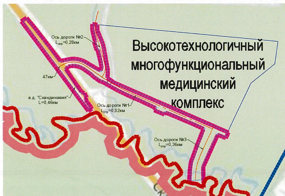
Рис. 1 Устройство проезда тремя дорогами
