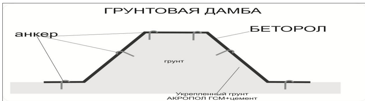
Рисунок 7.10 -Укрепление грунтовых дамб
