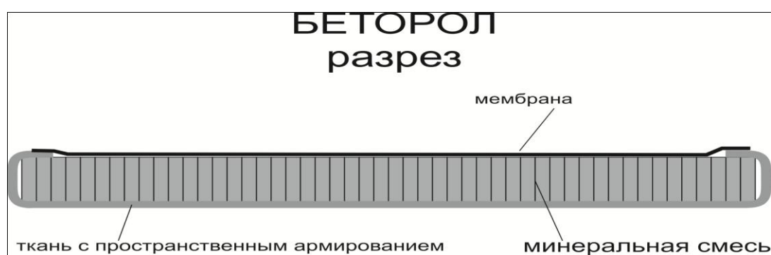
Рисунок 7.9 - Устройство гибкого полотна БЕТОРОЛ
