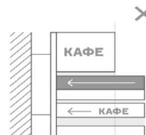
Запрещается устанавливать разногабаритные панели на один кронштейн. Запрещается устанавливать панели с разными отступами. Запрещается размещать указатель посередине или сверху группы, а так же дублировать его.
